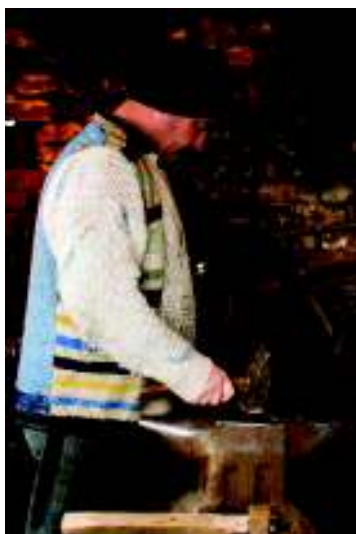
Fig. 5. Îndreptarea lamei metalice.
