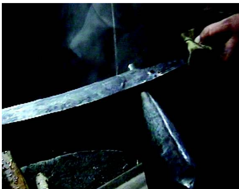
Fig. 17. Călirea diferențiată a tăișului.
